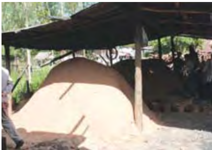
เตาเผาถ่านแบบเตาดินไร่คว้น ที่ไม่มีควันเกิดขึ้นขณะเผาถ่าน
