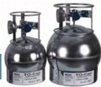
เครื่องเก็บตัวอย่างอากาศ ชนิด Canister
