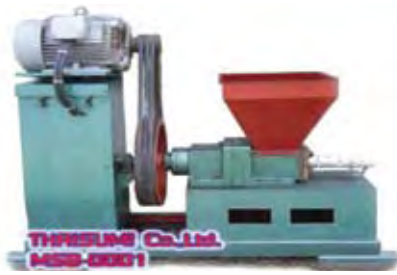
เครื่องอัดร้อนชี้เลื่อยกำลังสูง และแท่งชี้เลื่อยที่อัดเป็นแท่ง
