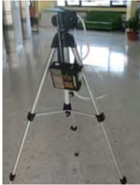
การเก็บตัวอย่างอากาศ ผ่านหลอดตัวกลาง
