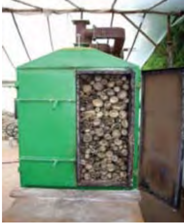
เตาเผาถ่านแบบเตาเหล็กมีความหนาแน่นเตาสูง
