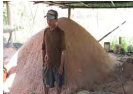
เตาเผาถ่านแบบเตาดินไร่คว้น ที่ไม่มีควันเกิดขึ้นขณะเผาถ่าน
